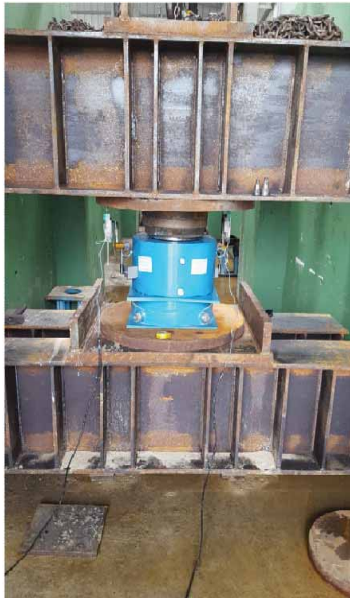
Figura 17 - Ensaio do aparelho especial em escala reduzida
